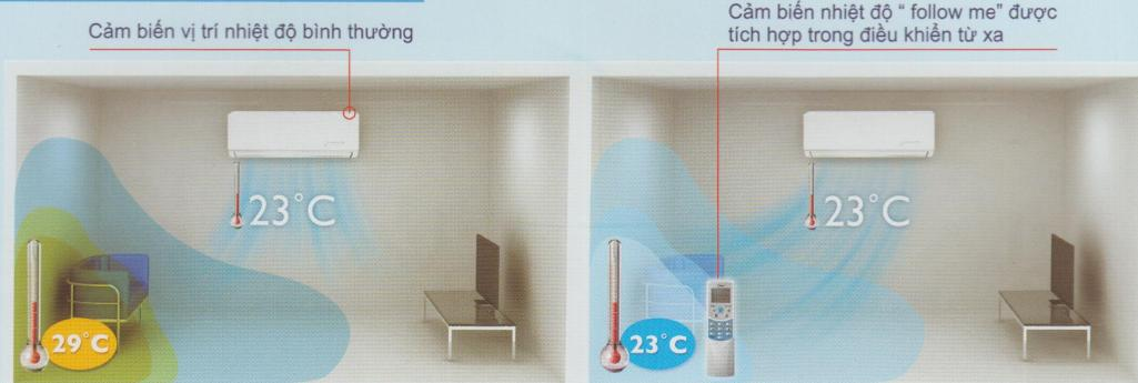
Với chức năng này, bộ cảm biến nhiệt độ phòng tích hợp trong điều khiển từ xa được kích hoạt và thay thế dàn lạnh trong nhà. Sau đó điều hòa không khí sẽ điều chỉnh nhiệt độ trong phòng dựa vào nhiệt độ xung quanh bộ điều khiển từ xa, giống như điều hòa không khí hướng theo người sử dụng.
